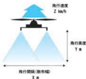
空中散布においては、散布方法（飛行速度、飛行高度、飛行間隔及び最大風速）の各要素が薬剤の拡散に影響を及ぼすため、均一散布及びドリフト抑制の観点では、全ての項目が明らかにされることが望ましい。
