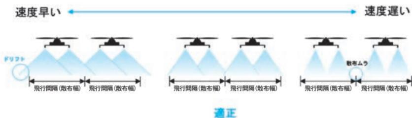
○飛行高度の違い（飛行速度及び飛行間隔が一定の場合）
