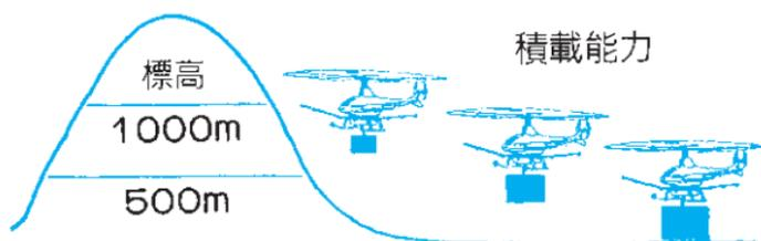
また、積載能力は機体の個体差などの要因でも変化しますので、散布飛行する立地条件を十分に確認し、余裕をもって農薬の積載量を決めて下さい。
